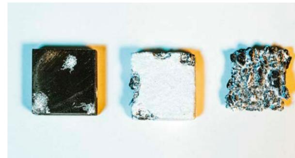
**1** Das Korrosionslabor von Hereon. Die Chemiker untersuchen, wie gut verschiedene Molekültypen Korrosion verhindern oder verzögern. Ein Laborroboter hilft, die Prozedur automatisch ablaufen zu lassen. Pro Woche werden so rund 50 neue Substanzen durchgetestet **2** Metalle in drei verschiedenen Korrosionsstufen. Links: kaum korrodiert. Rechts: sehr stark korrodiert
