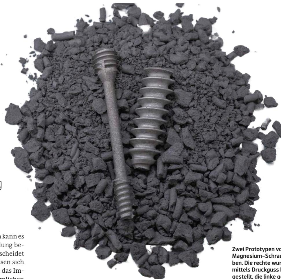
Zwei Prototypen von Magnesium-Schrauben. Die rechte wurde mittels Druckguss hergestellt, die linke gesintert. Beim Sintern wird Granulat aus Metallpulver bis knapp unter den Schmelzpunkt erhitzt und unter hohem Druck in Form gebracht
