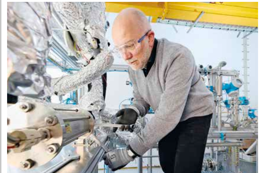
Ingenieur Torsten Brinkmann verschleißt einen Stahlzylinder, in dem Membranen installiert sind
